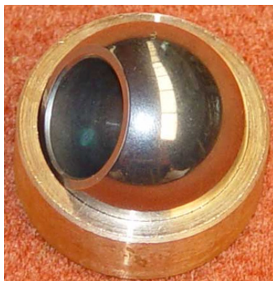
Рис. 6.3. Металлокерамический подшипник скольжения
