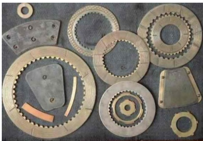
Рис. 6.5. Керамические фрикционные накладки, представляющие собой спеченную композицию из материалов с высоким коэффициентом трения (металло-, асболокно, кварциты, карбиды, оксиды, бориды), пропитанных твердой смазкой (Pb, Sn, Bi, оксиды Al, сульфаты Ba и Fe, графит)
